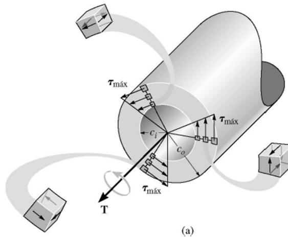
1) O tubo mostrado na figura tem um diâmetro interno de 80 mm e diâmetro externo de 100 mm. Supondo que sua extremidade seja apertada contra o apoio em A por meio de um torquímetro em B, determinar a tensão de cisalhamento desenvolvida no material nas paredes interna e externa ao longo da parte central do tubo quando são aplicadas forças de 80 N ao torquímetro.
