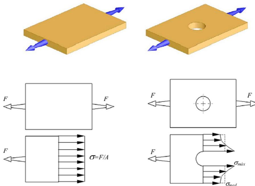
No dimensionamento de componentes com essas características, a tensão máxima ( $\sigma_{max}$ ) deve ser considerada de forma que não ultrapasse o limite de resistência do material ( $\sigma_E$  ou  $\sigma_R$ ).
