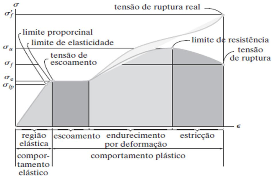
Diagramas de tensão-deformação convencional e real para um material dúctil (aço)(não está em escala)
