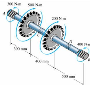
2) O eixo maciço de alumínio tem diâmetro de 50 mm. Determinar a tensão de cisalhamento máxima absoluta nele desenvolvida e traçar o gráfico da distribuição cisalhamento-tensão ao longo de uma reta radial onde o cisalhamento é máximo. Considerar  $T_1 = 20 \text{ Nm}$ .
