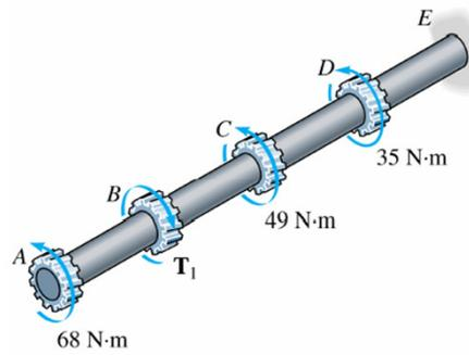
3) O eixo de aço está submetido à carga de torção mostrada. Determinar a tensão de cisalhamento desenvolvida nos pontos **A** e **B** e desenhar o gráfico da tensão de cisalhamento nos elementos de volume localizados nesses pontos. O eixo onde **A** e **B** estão localizados tem raio externo de 60 mm.
